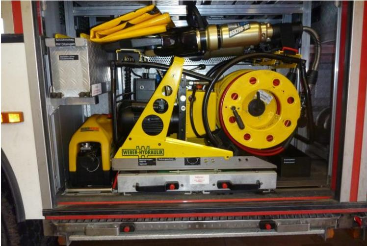
Im Rüstwagen wurde ein tragbares **Elektro-Compact Hydraulikaggregat** eingebaut. Entfernt wurden die Unterbauschiebeblöcke.
