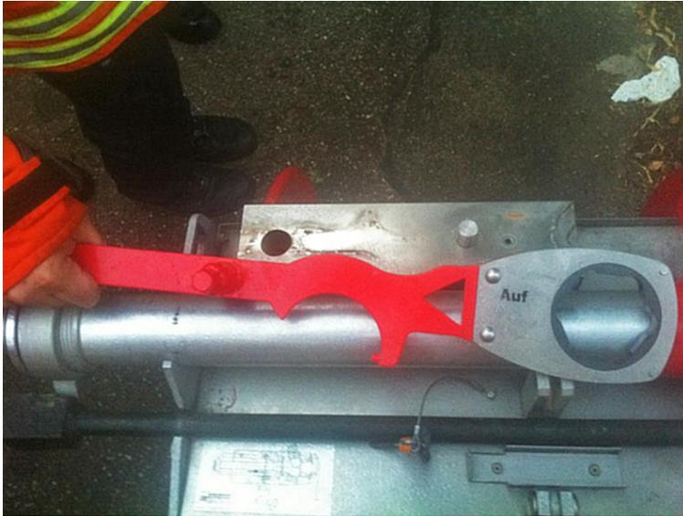
In jedem Löschfahrzeug wurde eine **Ratschenschlüssel Typ B für Überflurhydranten** nachgerüstet.
