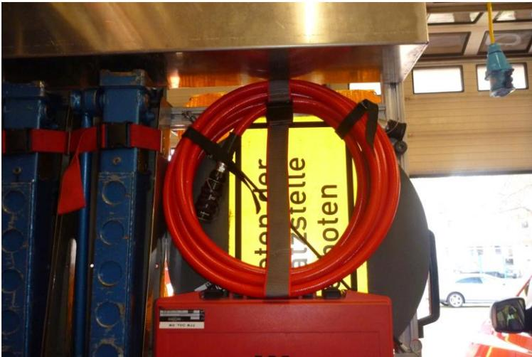
Der zehn Meter lange **Single-schlauch für das Hydraulikaggregat** befindet sich im G 2, auf der Auszugseite vom Glas-master.
