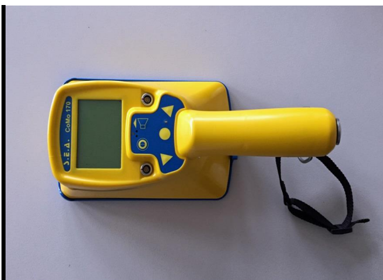
Ein Kontaminationsnachweisgerät CoMo 170 vervollständigt die Strahlenschutz-ausrüstung.
