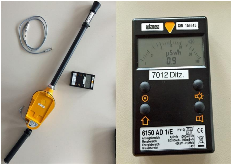
Ein Dosisleistungsmesser mit Teleskopsonde und Alpha-Beta-Gamma-Sonde gehört zu den Strahlenschutzmessgeräten.
