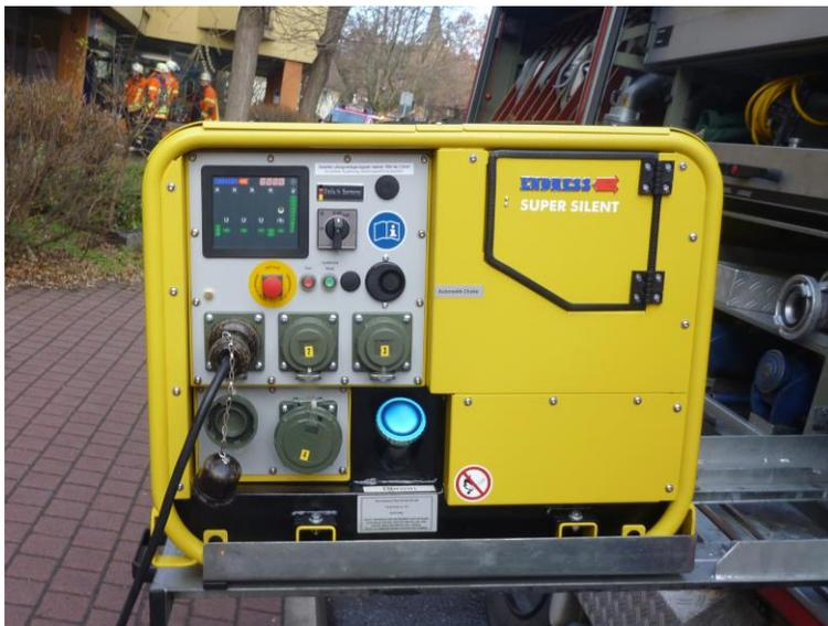
Im LF 16 TS ist ein neuer **Stromerzeuger**. Die Probleme beim Einsatz eines PRCD-Schalters sind damit kein Thema mehr.
