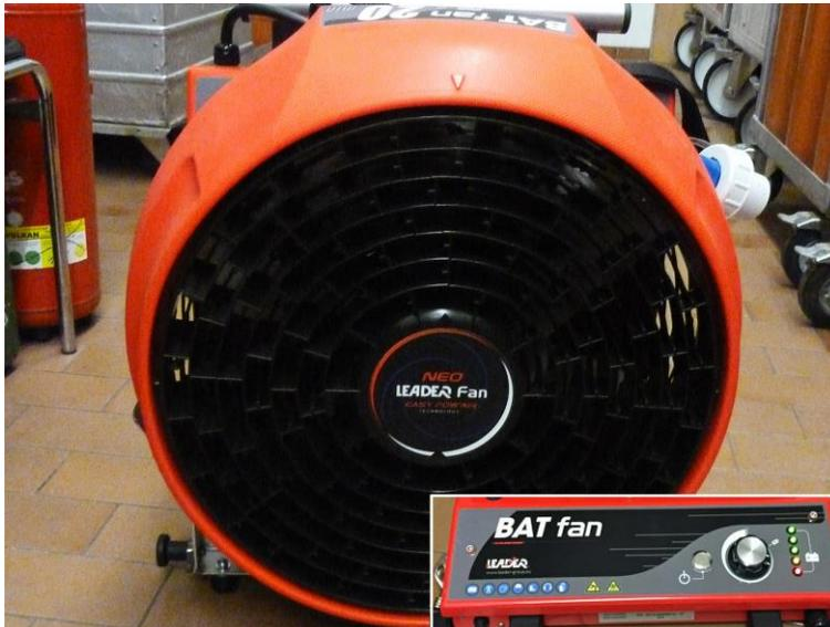
Ein **Akku betriebener Hochleistungslüfter** wird jetzt in der Drehleiter mitgeführt. Nach Erschöpfung der 20minütigen Akkukapazität kann der Lüfter auch über einen Generator versorgt werden.
